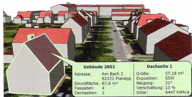
Optisch eher schlicht, dafür intelligent ist dieses Modell des Start-up Unternehmens Geoplex. In das LOD2-Modell sind Sachinformationen integriert. // What it lacks in terms of visual impact, this model of the start-up company, Geoplex, makes up for by its intelligence, as the LOD2 model integrates useful factual data. Photo: Geoplex.
